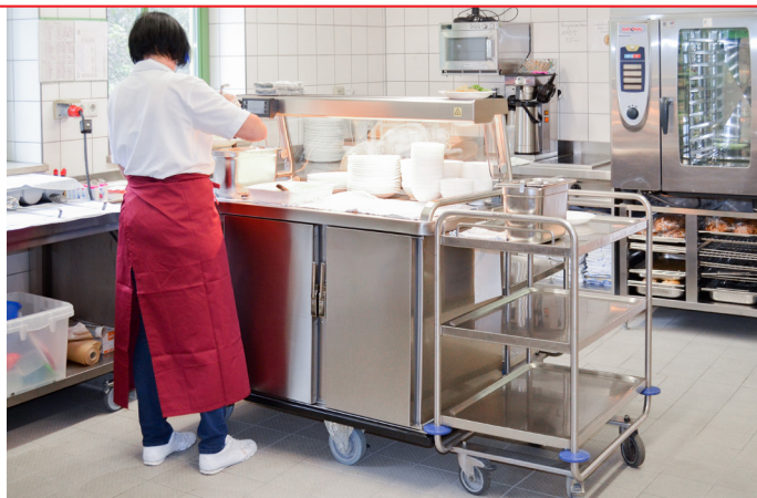
Die Speisen, die An Guadn liefert, werden in den jeweiligen Einrichtungen automatisch in den Warm-Bufferwagen Temp-Classic Pro M von Temp-Rite regeneriert und anschließend umgehend portioniert und ausgegeben.
